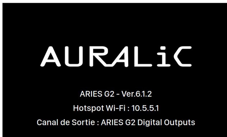
Lorsque l'ARIES G2.2 démarre, vous êtes accueilli par l'écran de bienvenue (ci-dessus), qui affiche le modèle de votre appareil, la version du micrologiciel, le type de connexion réseau actuel, l'adresse IP de votre appareil et le canal de sortie utilisé.
