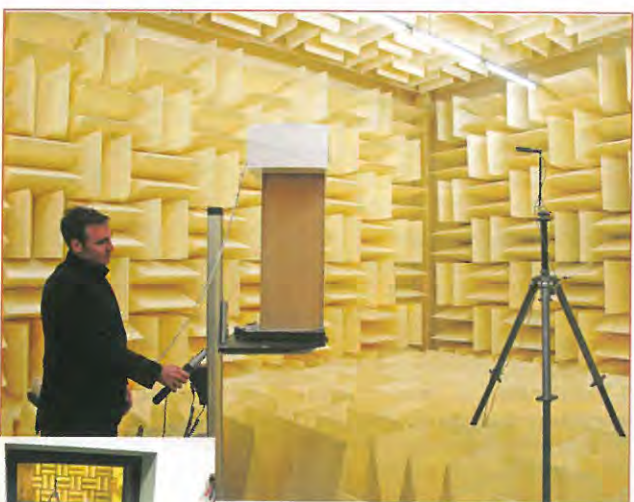
Vue de la chambre anéchoïque de Triangle afin de réaliser des mesures répétitives, toujours dans les mêmes conditions, seules garantes de valeurs justes que l'on peut exploiter sans être mises en doute.
