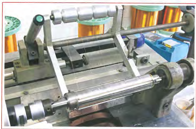
Vue de la machine à bobiner de très grande précision capable de réaliser des bobinages avec une couche externe et une couche interne.
